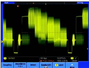
查看 NTSC 视频信号。MSO/DPO3000 系列快速波形捕获速率与信号辉度等级视图相结合，与模拟示波器一样提供了信息丰富的显示画面，但内容要详细得多，并拥有数字示波器的全部优势。
