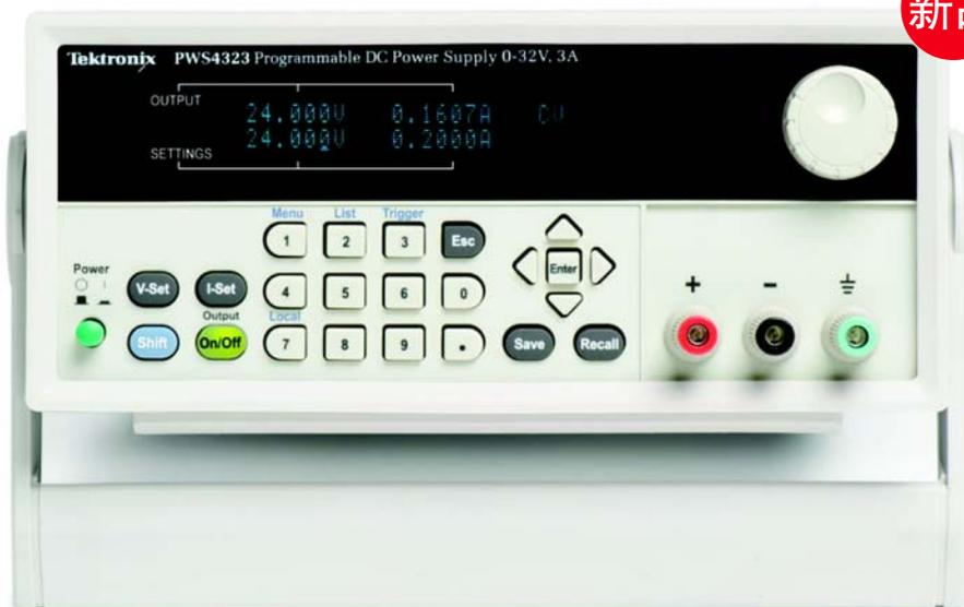
PWS4000程控电源系列提供了宽电压和电流范围，为您的工作台提供了一台多功能仪器。0.03%的基本电压精度及<5 mV<sub>p-p</sub>的噪声，使您能够对电源输出值建立信心。列表模式和远程编程使用的USB端口加快了开发复杂测试用例的速度。PWS4000系列电源可以为您的应用迅速准确地提供所需的处理能力。
