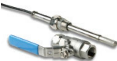
DMT348的探头可调节安装深度, 适合于安装在带压环境中, 探头在系统运行时根据需要可以方便取出。
